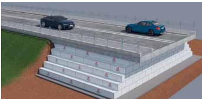
Figura 1 Një metodë e përdorur për të zëvendësuar mbushjen e dheut në autostrada, ura dhe postblik pas lehtësuar ngarkesën e projektimit.
