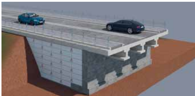
Figura 2 Parandalimi i mbushjeve e në strukturat e aksesit të urës që mbushin shpatet në tokë të butë.
