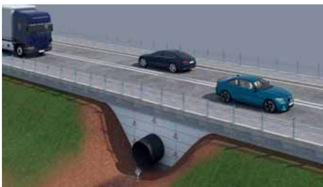
Figura 3 Mbushje për mbrojtjen e tubacioneve nëntokësore, objekteve të infrastrukturës kulluese që janë të ekspozuara ndaj ngarkesës së lartë vertikale.
