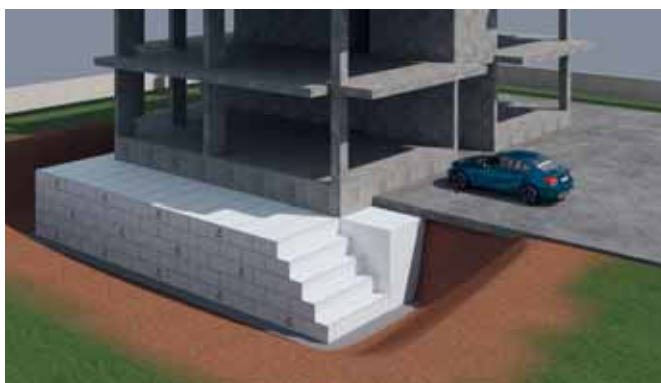
Figura 4 Mbushja e aplikacioneve për reduktimin e ngarkesave sismike anësore në strukturat mbështetëse dhe themelet.
